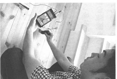
導電性シート施工の居室。値は9V/m！
